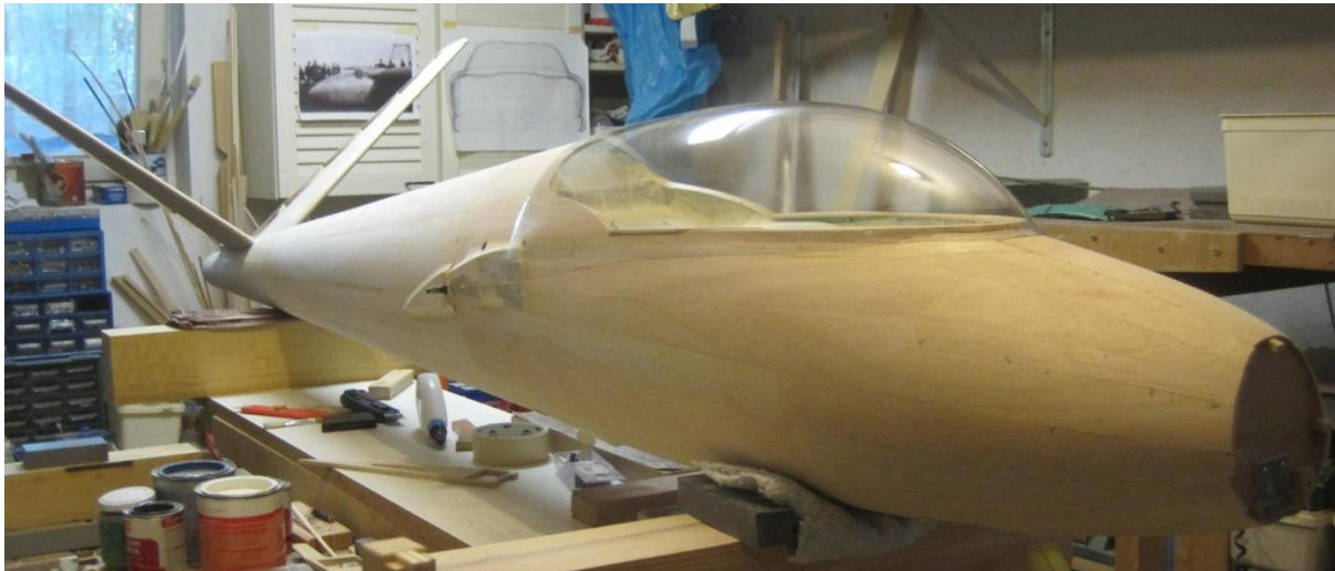
Rumpf mit Balsabeplankung und aufgelegter Haube [4]
