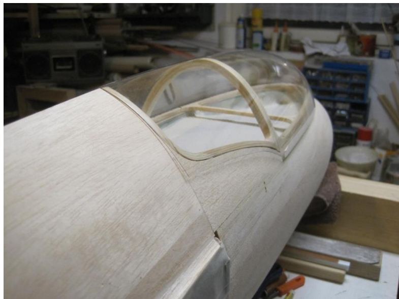
Der Haubenrahmen im Rohbau mit aufgelegter Haube [4]
