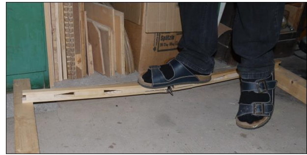
Belastungsprobe der Holmverbindung [2]
