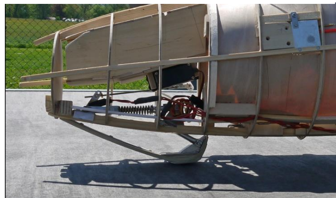
Die Kufe ausgefahren mit Mechanik und Servo, darüber der Akkusack [2]
