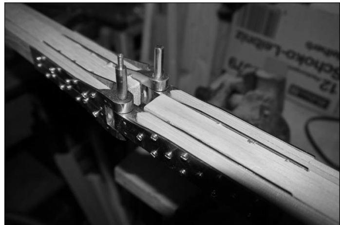
Holmverbindung mit zwei Hauptbolzen [2]
