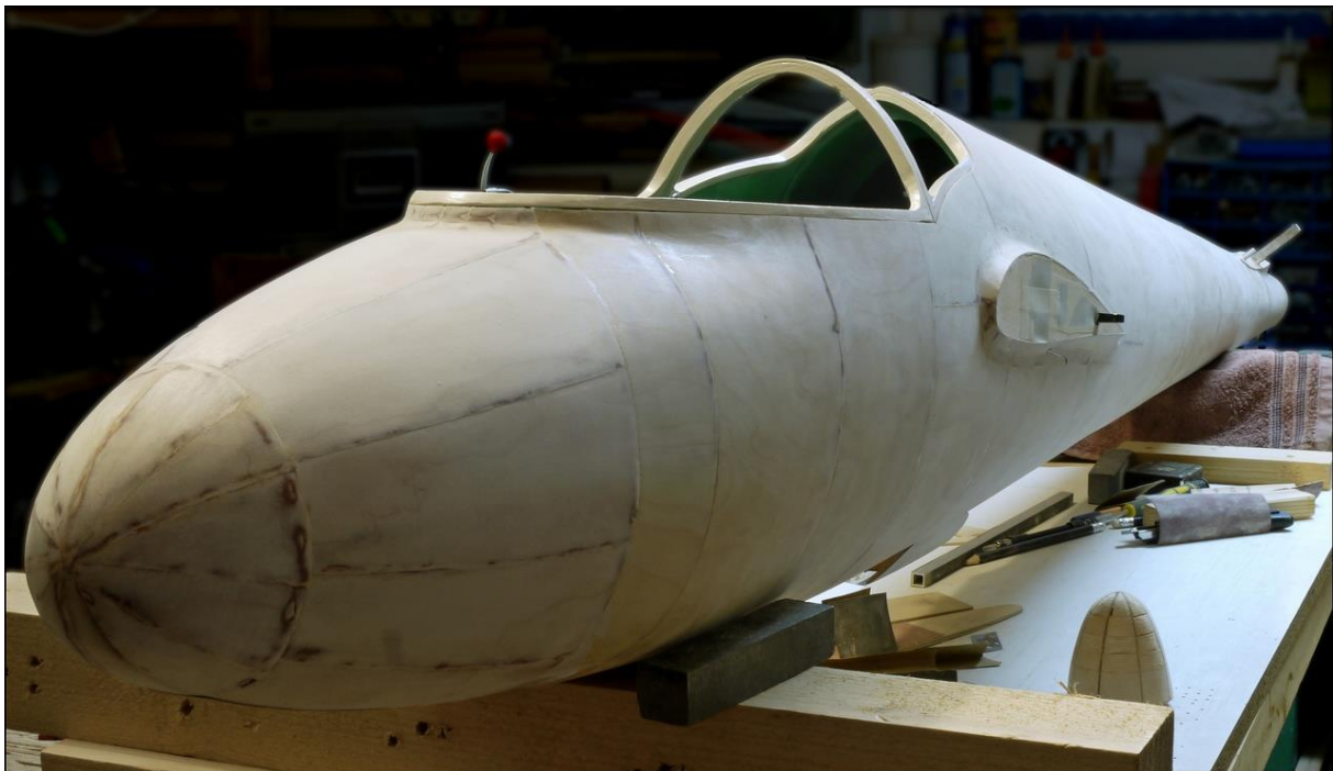
Der Rumpf nach der Beplankung mit Sperrholz [2]
