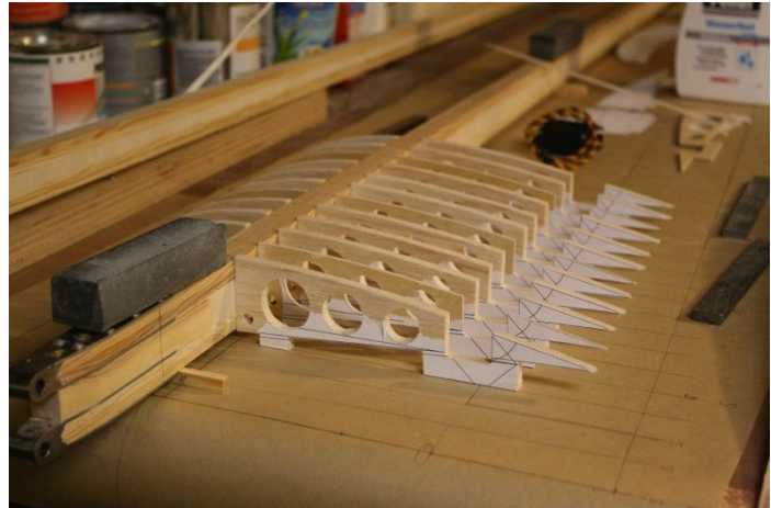
Rippen mit Erleichterungslöchern [4]
