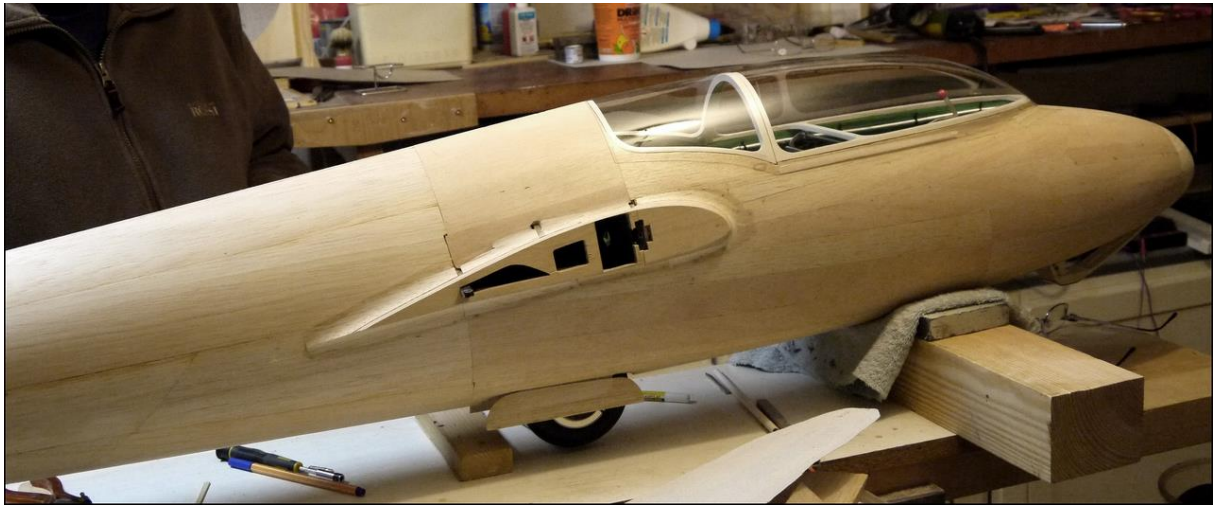
Flügelanformung in Balsa [2]
